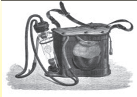
1862 Dumas et Benoît's Electrical miner lamp
